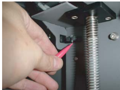
⑤歯間ブラシを使用して、上部Z軸センサーを掃除する。
