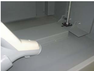
①加工テーブル内部を掃除機を使用して掃除する。
