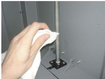
②ウエス(布切れ)を使用して、Z軸シャフトを掃除する。
