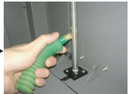
③白色グリース(工業用グリース)を使用して、Z軸シャフトに付着させる。
