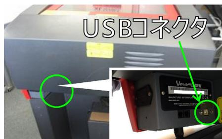
PC・レーザー機の電源を OFF にした状態で、一度 USB ケーブルを抜いてから改めて接続し直すのも有効です。
